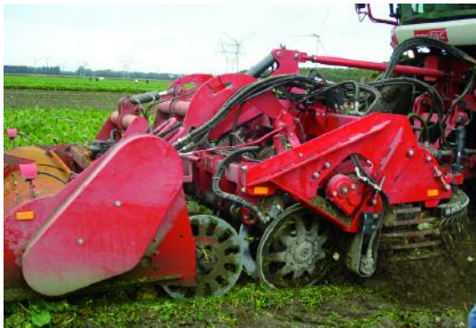
GRÁFICO 8.- CONJUNTO DESCORONADOR + ARRANCADOR CON RUEDAS ACCIONADAS (AGRIFAC)
