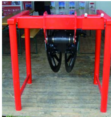
GRÁFICO 9.- RUEDAS ACCIONADAS (OPPEL) O REJAS CON MOVIMIENTO ALTERNATIVO, OFRECIDAS COMO OPCIÓN POR EL MISMO FABRICANTE (AGRIFAC)
